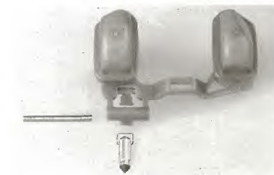
Bild 70 Schwimmer mit Achse und Ventilkegel
