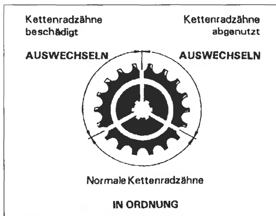
Bild 51 Kettenradverschleiss und -beschädigung
