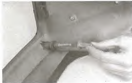
Bild 11 Spezialmuttern der Lampen- verkleidung lösen
