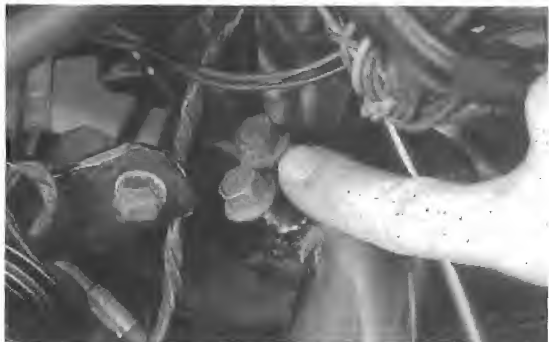
Bild 155 Klemmschrauben an unterer Gabelbrücke
