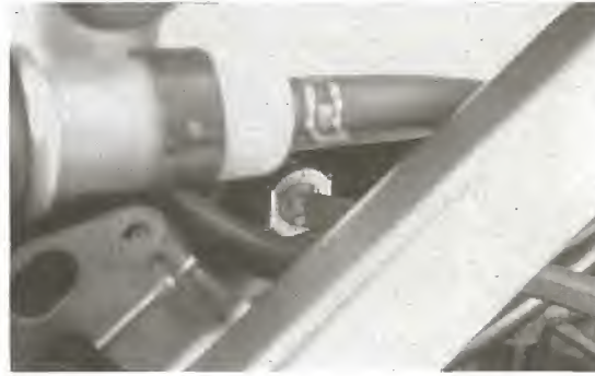
◀ Bild 4 Stecker des Kraftstoffstand- gebers lösen
