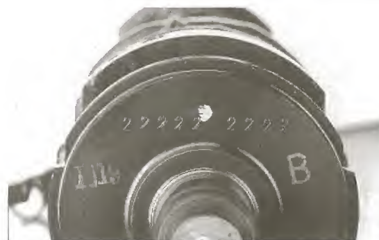
Bild 149 Eingeschlagene Lagerzapfen- und Hubzapfen-Kennzeich- nung
