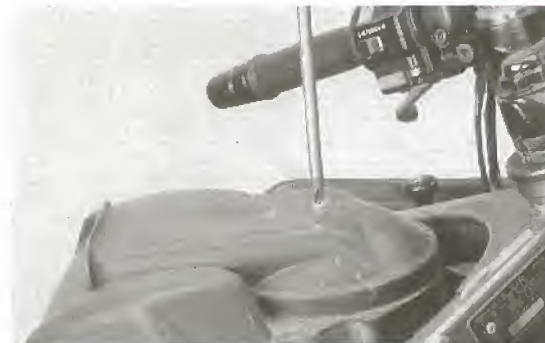
Bild 13 Befestigungsschraube des Luftfilterdeckels ausdrehen
