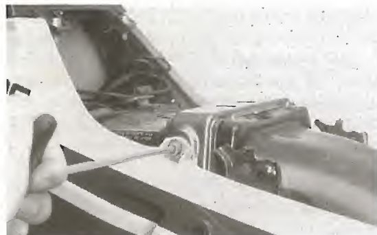
Bild 3 Hintere Seitenverkleidung lösen
