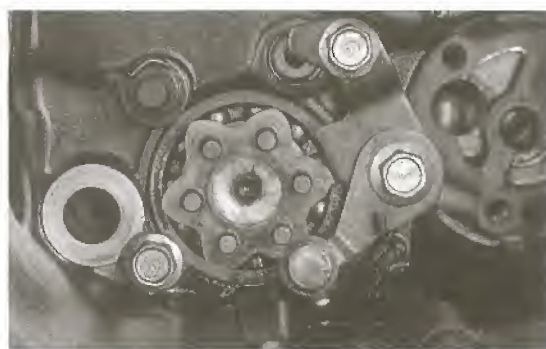
◀ Bild 95 Gehäuseschraube an Pumpenrückseite
