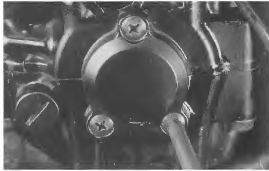
Bild 19 Kurbelstumpf­abdeckung und Stopfen der Kontrollbohrung abnehmen
