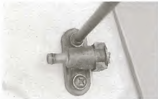
Bild 12 Befestigungsschrauben des Kraftstoffhahns ausdrehen
