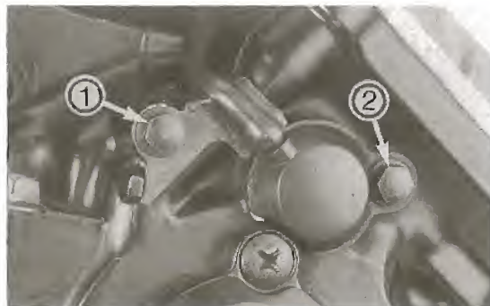
Bild 83 Befestigungsschrauben von Kabelhalter 1 und Zündpickup 2
