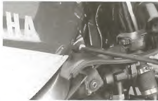
◀ Bild 6 Befestigungsschraube des Kraftstofftanks lösen
