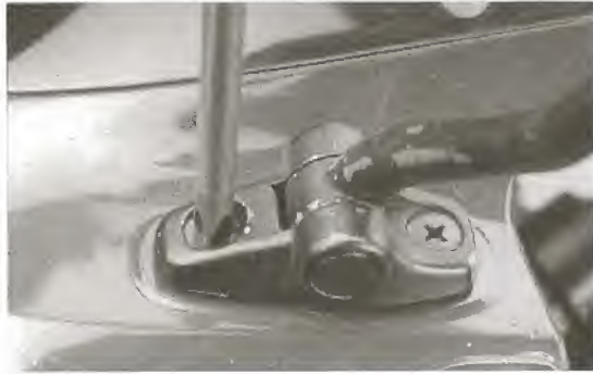
Bild 10 Verkleidungsschrauben der Spiegelbefestigung lösen
