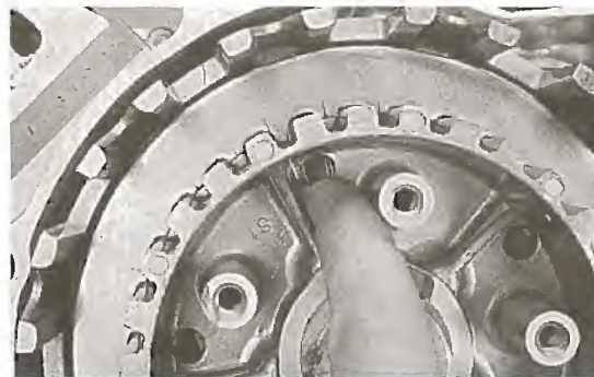
Bild 87 Überprüfen der Drahtsicherung
