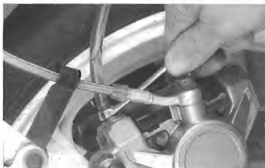
Bild 45 Entlüftungsventil \frac{1}{4} bis \frac{1}{2} Umdrehung öffnen
