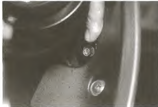
Bild 61 Seiteneinstellschraube des Scheinwerfers
