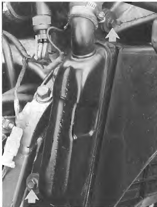
Bild 17 Befestigungsschrauben des Kühlers
