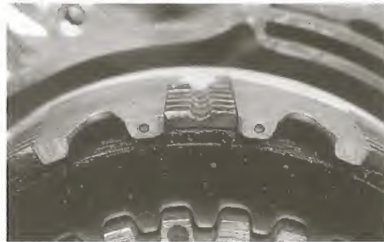
Bild 105 Einbaulage der Reibscheiben mit Nut
