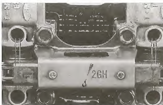
Bild 26 Nockenwellenmarkierungen mit Lagerdeckelmarkierungen ausrichten
