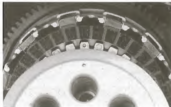
Bild 107 Punktmarkierungen müssen fluchten
