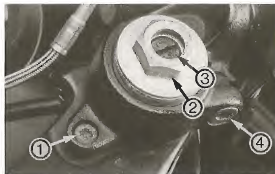
Bild 52 Lenker und Gabel 1 Lenkerbefestigungsschraube 2 Obere Gabelverschlusschraube 3 Federvorspannung-Einsteller 4 Lenkerklemmschraube
